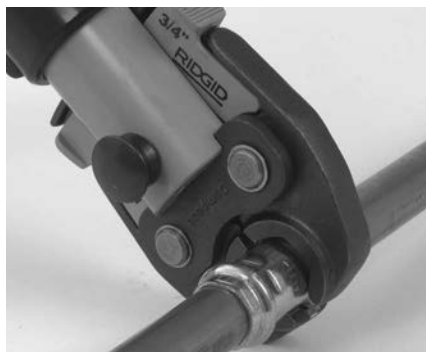
Figur 7 – Placera käftar av saxstål runt beslaget
