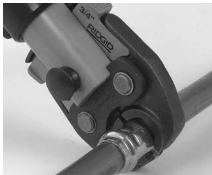
Obrázek 7 – Umístění nůžkových čelistí kolem armatury
