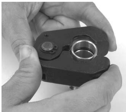
Rysunek 9 - Montaż pierścienia zaciskowego na okuciu
