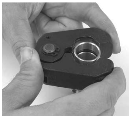
Εικόνα 9 – Τοποθέτηση δακτυλίου πρεσαριστής σύνδεσης στον σύνδεσμο
