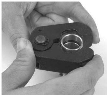
Figura 9 – Montarea inelului de presare pe fitting
