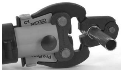
Slika 10 – Postavljanje aktuatora na prstenastu presu
