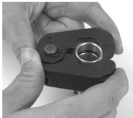
Slika 9 – Postavljanje prstenaste prese oko priključka
