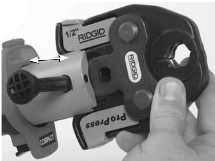
Рис. 6 – Штифт крепления насадки
