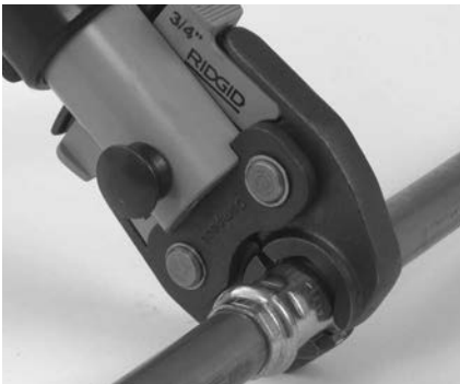
Rysunek 7 – Umieszczanie szczęk nożycowych wokół okucia
