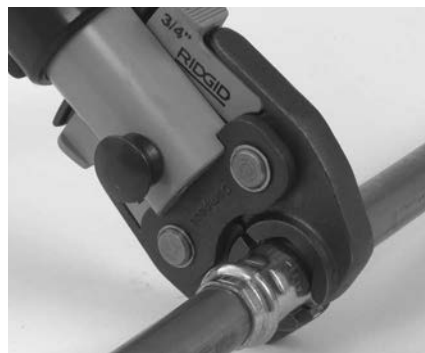
Figur 7 – Placering af saksekæber omkring fitting
