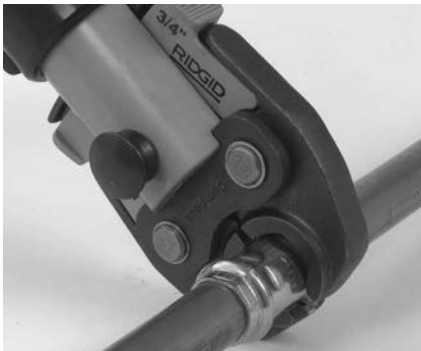
Figura 7 – Așezarea fălcilor tip foarfece în jurul fittingului
