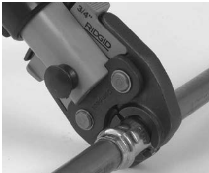
Kuva 7 – Saksityyppisten leukojen asettaminen liittimen ympärille
