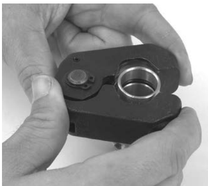
Figuur 9 – Aanbrengen van de persring op de fitting
