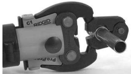
Figur 10 – Feste aktuatoren til pressingen
