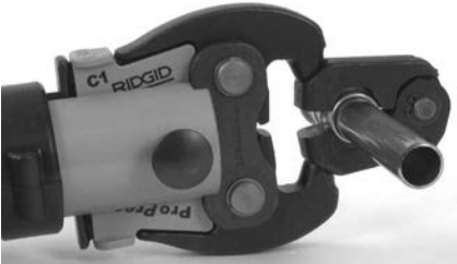
Figur 10 – Fästa aktuatoren på pressringen
