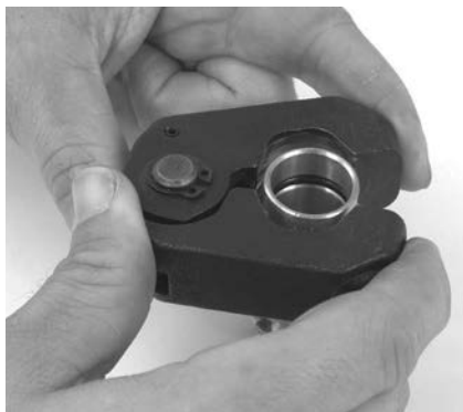
Figur 9 – Påsætning af pressering på fitting
