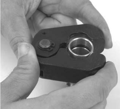
Figur 9 – Sätta dit pressringen på beslaget
