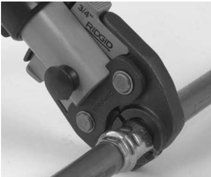
Abbildung 7 – Anbringen von Scherenbacken am Fitting
