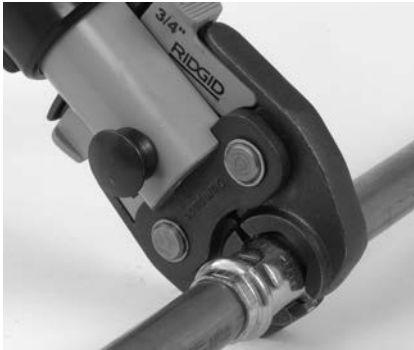
Figure 7 – Positionnement des mâchoires à cisaille autour du raccord
