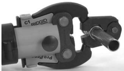
Obrázek 10 – Připojení pohonu k lisovacímu kroužku
