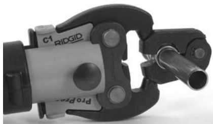
Figura 10 – Atașarea actuatorului la inelul de presare
