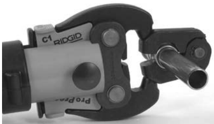
10. ábra - Működtető elem rögzítése a présgyűrűn
