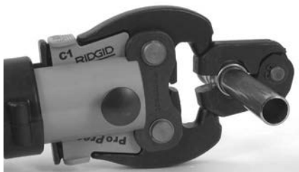
Slika 10 – Pričvršćivanje aktuatora na prsten za prešanje
