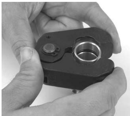
Slika 9 – Montaža prstena za prešanje na priključak
