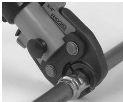
Slika 7 – Postavljanje makazastih čeljusti oko priključka
