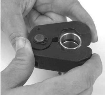
Рис. 9 – Установка обжимного кольца на фитинг
