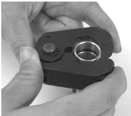
9. ábra - Présgyűrű elhelyezése a csőcsatlakozón
