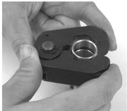
Obrázok 9 – Inštalácia lisovacieho krúžka na tvarovku
