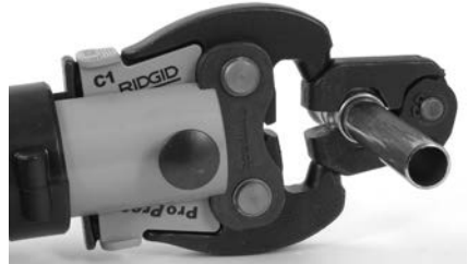
Figura 10 – Montaje del accionador en el aro sellador
