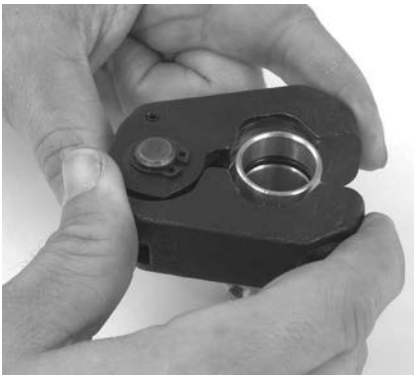
Abbildung 9 – Anbringen des Pressrings am Fitting
