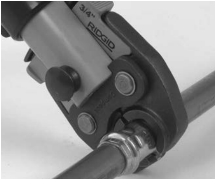
7. ábra – A szerelvény körülzárása ollós pófákkal
