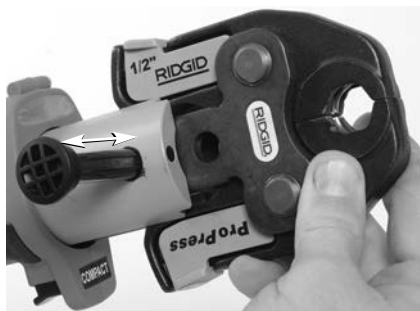
Figure 6 – Broche de retenue de tête
