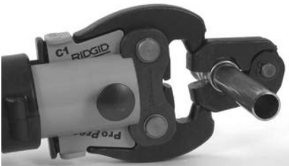
Abbildung 10 – Ansetzen des Stellantriebs am Pressing
