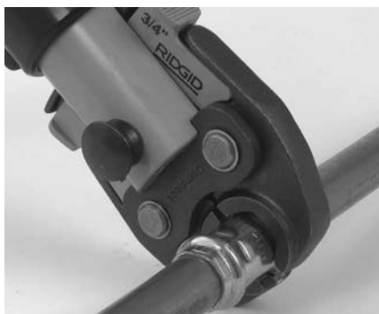
7-сурет – Қайшы тәрізді қармауыштарды фитинг айналасына орналастыру
