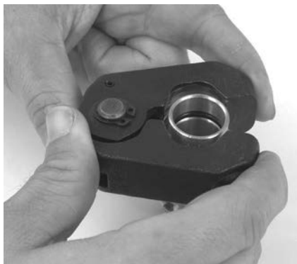
Figura 9 - Installazione dell'anello di pressatura sul raccordo
