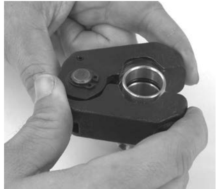
Figur 9 – Installere pressingen på utstyret
