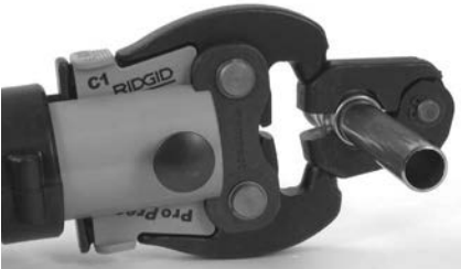
Kuva 10 – Toimilaitteen kiinnittäminen puristusrenkaaseen
