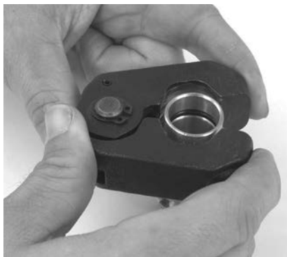
Obrázek 9 – Instalace lisovacího kroužku na armaturu
