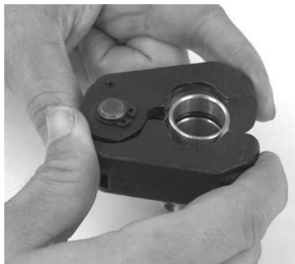
Slika 9 - Nameščanje obroča za stiskanje na nastavek
