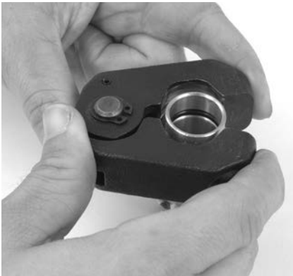
Figura 9 – Montaje del aro sellador en el acoplamiento
