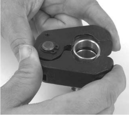
Şekil 9 – Pres Halkasının Tespit Elemanı Üzerine Takılması
