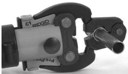
Figura 10 – Prender o atuador no anel de prensagem
