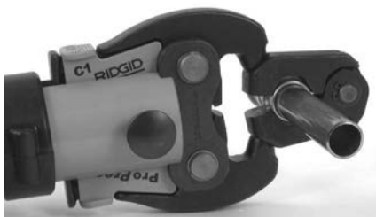
Figur 10 – Fastgørelse af aktuator på pressering
