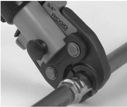
Figuur 7 – Aanbrengen van schaarbekken rond fitting
