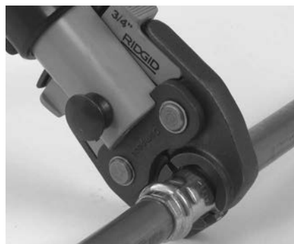
Obrázok 7 – Umiestnenie nožnicových čelustí okolo tvarovky
