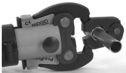
Obrázok 10 – Pripojenie akčného člena k lisovaciemu krúžku
