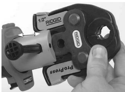
Figur 6 – Monteringsstap til tilbehør
