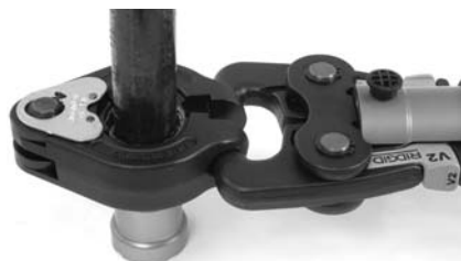
Figure 10A – Engagement des pinces de l'actionneur V2 dans les dépressions de la bague de sertissage
