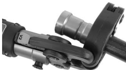
Figure 10B – Engagement à 90° de l'actionneur V2 dans la bague MegaPress en cas de manque de refuite
