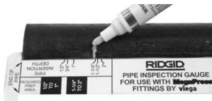
Figure 5B – Valiéndose de un calibrador MegaPress® de RIDGID®, marque hasta dónde debe insertarse el tubo dentro del acoplador
