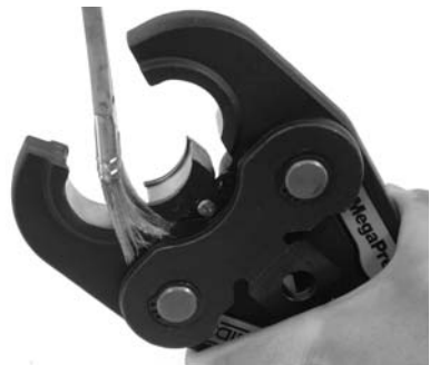
Figure 11 – Nettoyage des axes d'une mâchoire MegaPress
