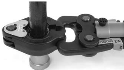
Figure 10A – Las puntas del accionador V2 metidas en las cavidades del aro MegaPress
