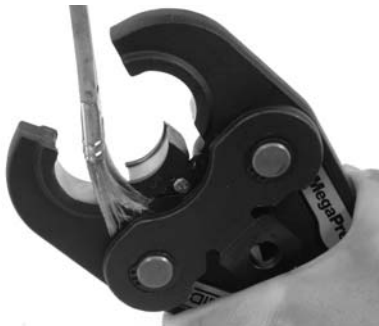
Figure 11 – Limpieza con escobilla de las superficies interiores de una mordaza MegaPress
