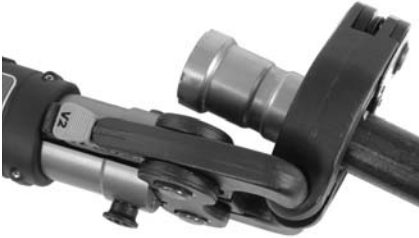
Figure 10B – Las puntas del accionador V2 metidas en las cavidades del aro formando un ángulo con el aro para mayor maniobrabilidad
