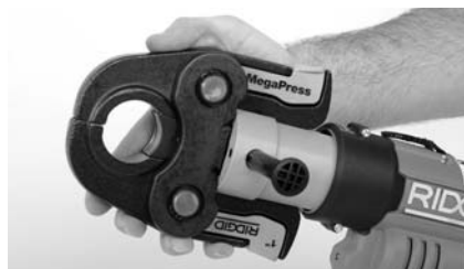
Figure 3 – Retrait d'un outil de sertissage
