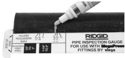
Figure 5B – Repérage de la profondeur d'insertion du tuyau à l'aide d'une jauge de contrôle RIDGID® MegaPress®
