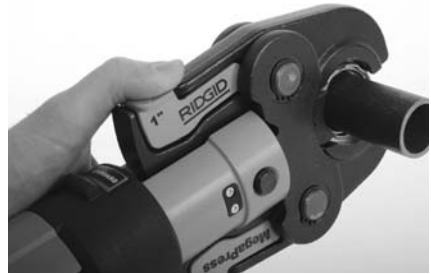
Figure 7 – Ouverture et positionnement des mâchoires MegaPress sur le raccord
