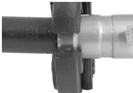
Figure 8 – Mordazas MegaPress colocadas en ángulo recto en relación con el acoplador y el tubo
