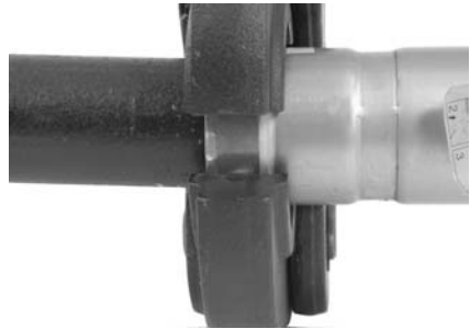
Figure 8 – Mâchoires MegaPress tenues à l'équerre du raccord et du tuyau
